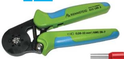
Tipo a regolazione automatica delle ganasce di serraggio. Regolazione manuale della pressione di serraggio. In acciaio speciale, parti operanti temprate e rettificate. Impugnature ergonomiche in materiale bicomponente. Con dispositivo di sbloccaggio in caso di cablaggi difettosi. Per cablaggi a sezione esagonale e inserimento laterale del terminale a bussola.
